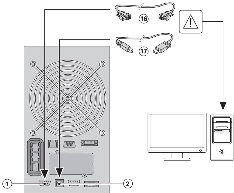
1. Подсоединить кабель связи RS232 ⑯ или USB ⑰ к последовательному порту или порту USB компьютера.
