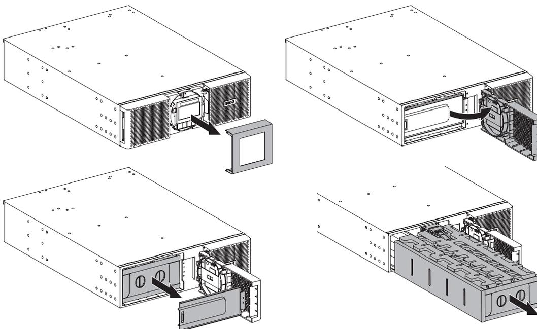
4. Выньте пластиковую ручку от аккумуляторной батареи и медленно перемещайте батарею по ровной и устойчивой поверхности. Используйте две руки для поддержки аккумуляторной батареи. Положите ее в стороне для установки после того, как ИБП будет горизонтально установлен.
