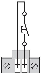
Когда состояние контакта изменяется с разомкнутого на замкнутый, то ИБП включается (или остается Вкл). Когда состояние контакта изменяется с замкнутого на разомкнутый, то ИБП выключается (или остается Выкл).
