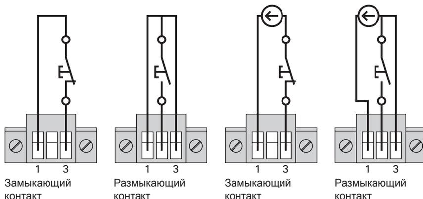
Номинальный размер провода клеммы равен 0,32-4 мм<sup>2</sup> (22-12 AWG).
