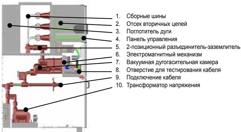
Рис. 2-1. КРУ с автоматическим выключателем на ток 630 / 800 А, вид в разрезе
