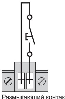
Когда состояние контакта изменяется с разомкнутого на замкнутый, то ИБП включается (или остается Вкл). Когда состояние контакта изменяется с замкнутого на разомкнутый, то ИБП выключается (или остается Выкл).
