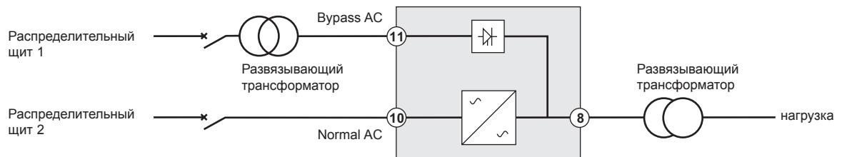
ИБП с трансформаторами гальваноразвязки
