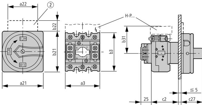
Размеры установочного отверстия, дверь
