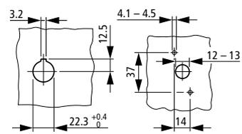
**Заднее крепление, модульное исполнение**
