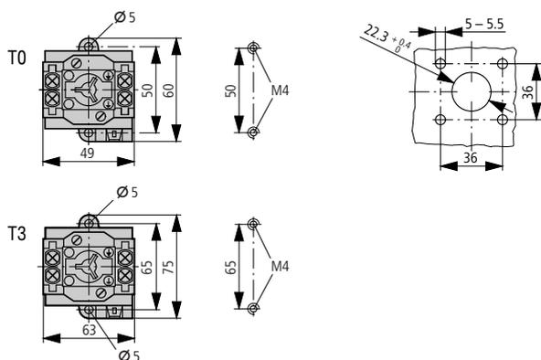
① Блокировка может быть удлинена с помощью ZVV-T0 + ZAV-T0, ≅ 4 x 25 = 100 мм
