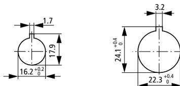
Переднее крепление (в отверстие Ø 22 мм), управление ключом
