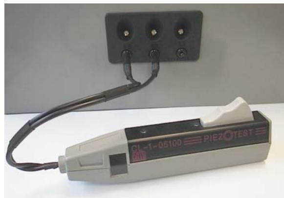
**Рисунок 4: Пьезотестер, включенный в гнезда L1 и L2**
