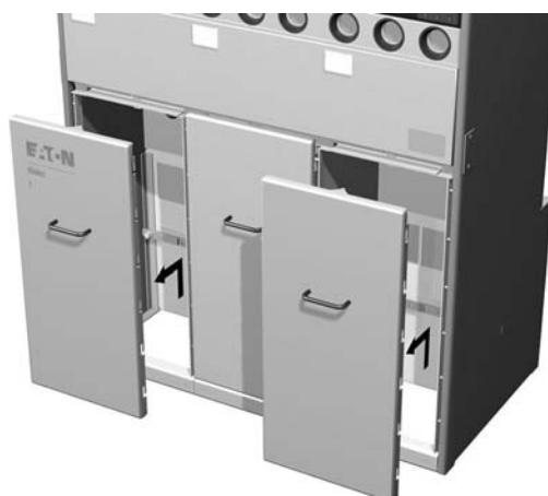
Рисунок 3-2: Выдвижение дверцы доступа к кабельному отсеку
