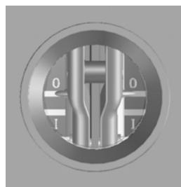
Рисунок 4-5: Двухпозиционный переключатель в положении заземления
