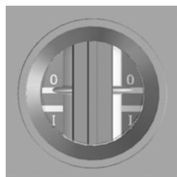
Рисунок 4-6: Двухпозиционный переключатель, подключенный к шине
