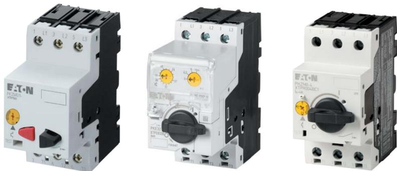
**PKZM0, PKZM4** — основные «классические» серии автоматических выключателей защиты двигателя, управляемых поворотной ручкой, в диапазоне токов 0,16-65 А.
