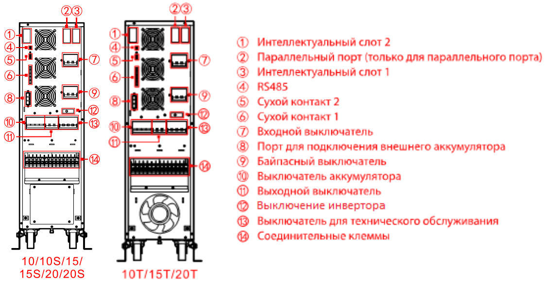
Рис. 2-6 Вид задней панели VGD-II-10-20K33HC
