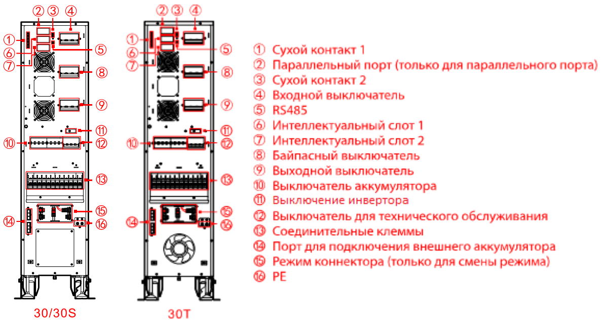
Рис. 2-7 Вид задней панели VGD-II-30K33HC
