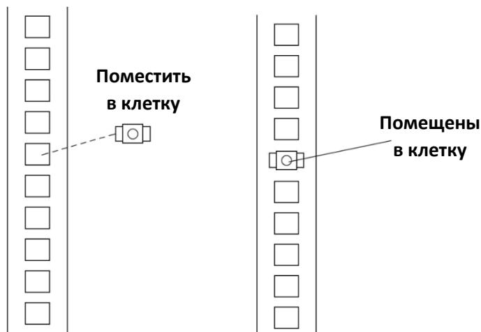
Совместите монтажные отверстия на кронштейне с установленными в клетку гайками, вставьте и поверните винт в затянутом положении
