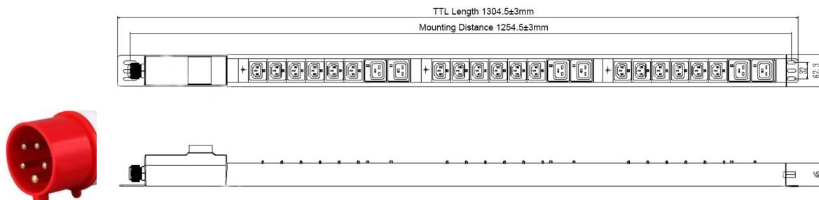
Металлический корпус, 19"OU 18 \*C13 + 6 \* C19 запирающиеся розетки, 3х полюсной автоматический выключатель, 5\* 6 мм 2 \*2 м, штекер 32A IEC 60309 5ти контактный, 3 индикатора питания
