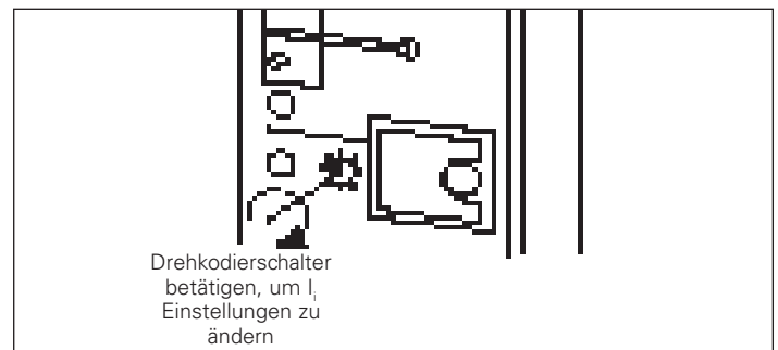
Abbildung 13. Auslöseparameter des unverzögerten Kurzschlussauslösers ändern
